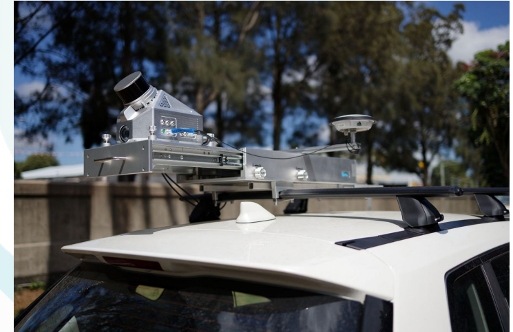
High precision LiDAR Mobile Mapper
